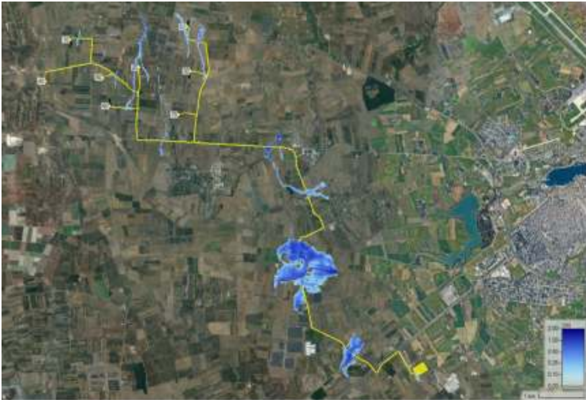
Fig. 6.2 - Panoramica delle aree inondabili in corrispondenza di cavidotti e aerogeneratori
