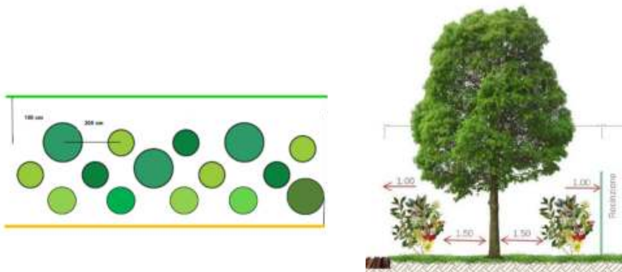
Fig. 7.1 - Schema planimetrico e sezione tipologica della fascia perimetrale di mitigazione visiva
