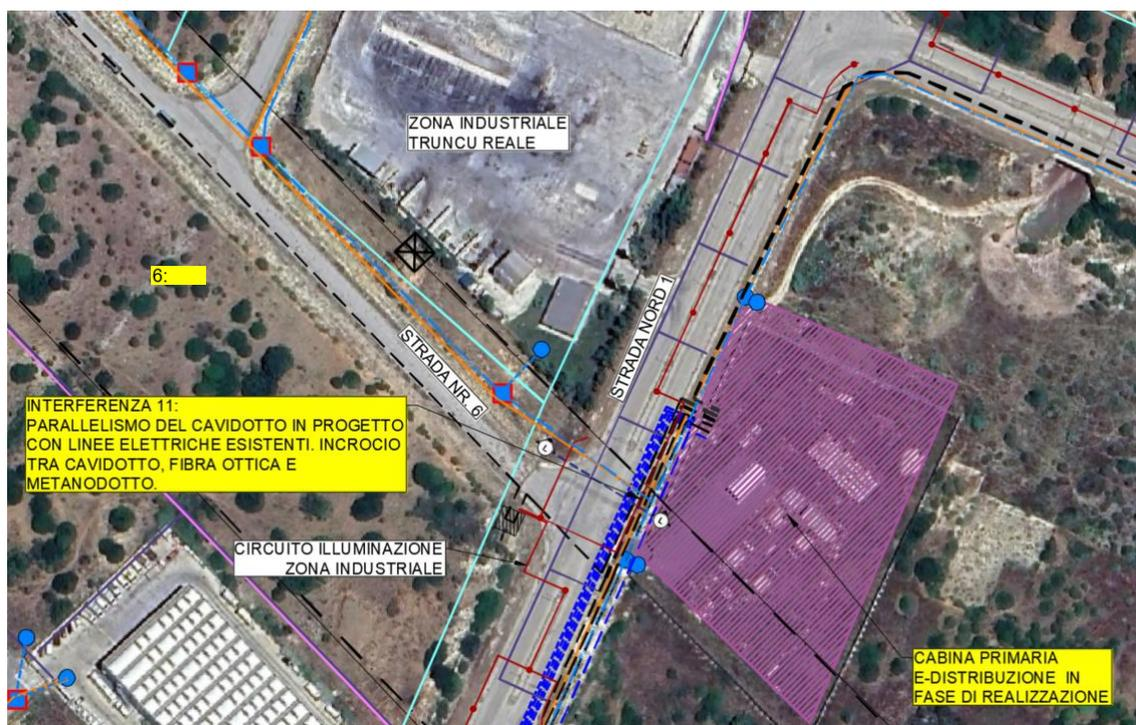
Figura 13: Planimetria interferenza 11
