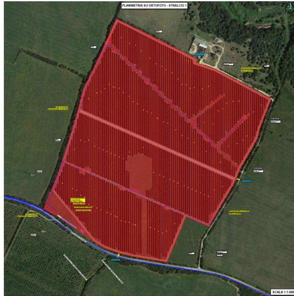
Figura 3-26 - Estratti della Tav. ELG\_322 di progetto raffigurante la logistica di cantiere dei 3 lotti
