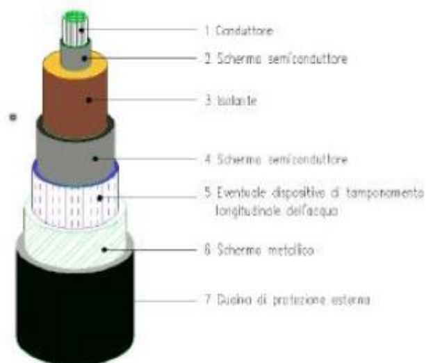
Figura 8 – Particolare cavo AT
