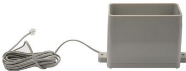
Sonda di potenziale matriciale inserita a 40 cm di profondità nelle vicinanze di un apparato radicale di vite da tavola (sinistra) e pluviometro per misurare l'effettivo volume di acqua fornito alle piante (destra).
