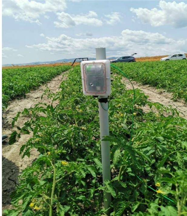
Figura 4: Datalogger a cui collegare i sensori per il potenziale matriciale (esempio in un impianto di pomodoro).
