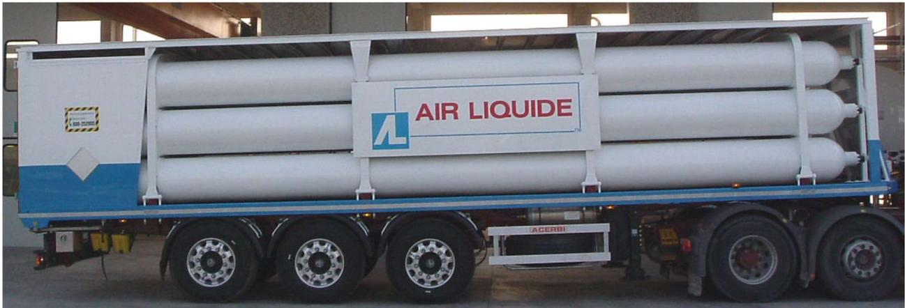
Figura 10: esempio di carro bombolaio per idrogeno
