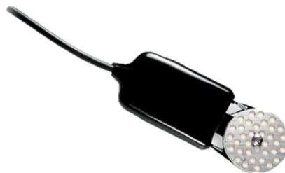
*Figura 2: Tipologia di sensore utilizzabile per misurare il potenziale matriciale*
