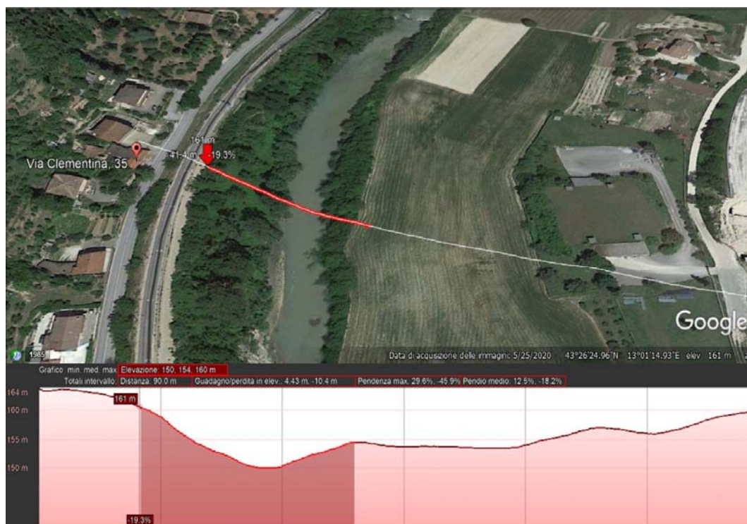
Figura 5 – Da sinistra, sezione trasversale altimetrica del sedime dell’ex canale Montedison, della riva sinistra, del letto del fiume Esino e della riva destra. Dall’osservazione del grafico si nota che il sedime dell’ex canale Montedison (Quota 160 m slm), edificato vicino alla riva sinistra del fiume, è posto a circa 10 m al di sopra letto del fiume Esino (Quota 150 m slm). Da tale grafico si può anche osservare che la riva sinistra ha una quota superiore rispetto a quella della riva golenale destra.
