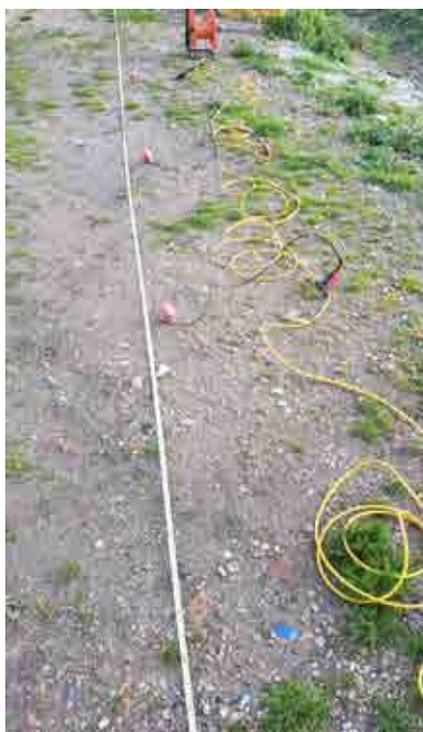
**Fig. 1 – Prospezione sismica MASW effettuata in area progettuale.**
