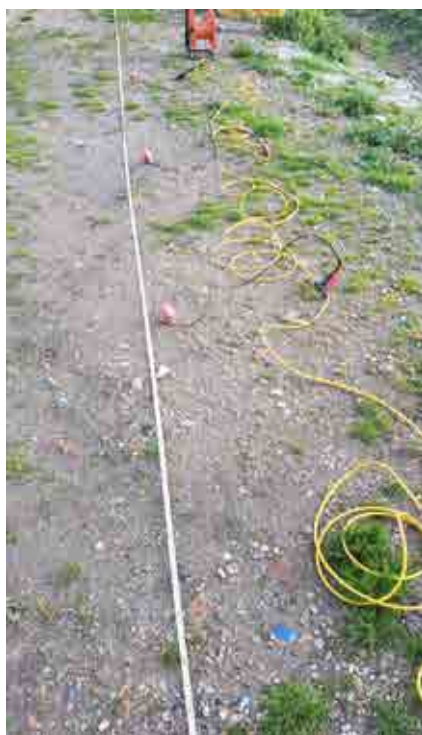
Fig. 1 – Prospezione sismica MASW effettuata in area progettuale.
