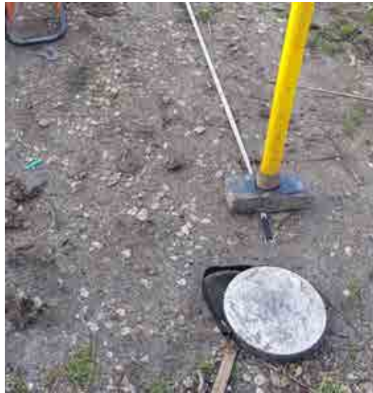
Fig. 13 – Sorgente energizzante, costituita da massa battente su piastra di alluminio. Come starter/trigger è stato utilizzato un geofono verticale Geospace a 14Hz.
