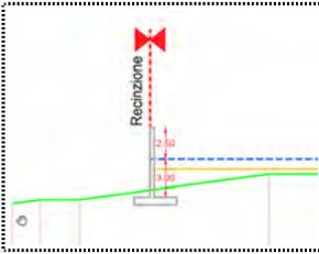
Sulla recinzione nord-ovest (§ DPHS 4) nella sezione Y2 è ubicato il muro di contenimento di altezza 5,50 m., esclusa fondazione, nella zona è presente un livello di 0,60 m. di sedimento alluvionale costituito da limi, sabbie e ghiaie assimilabili a sabbie sciolte (§ precedente capitolo 5.1 Parametri geotecnici caratteristici per il terreno di fondazione)..
