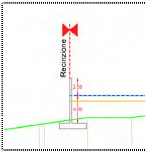
Sulla recinzione nord-ovest (§ DPHS 1) nella sezione Y1 è ubicato il muro di contenimento di altezza 6,50 m., esclusa fondazione, nella zona è presente un livello di 2,40 m. di sedimento alluvionale costituito da limi, sabbie e ghiaie assimilabili a sabbia da sciolta a molto sciolta con addensamento progressivo (§ precedente capitolo 5.1 Parametri geotecnici caratteristici per il terreno di fondazione).
