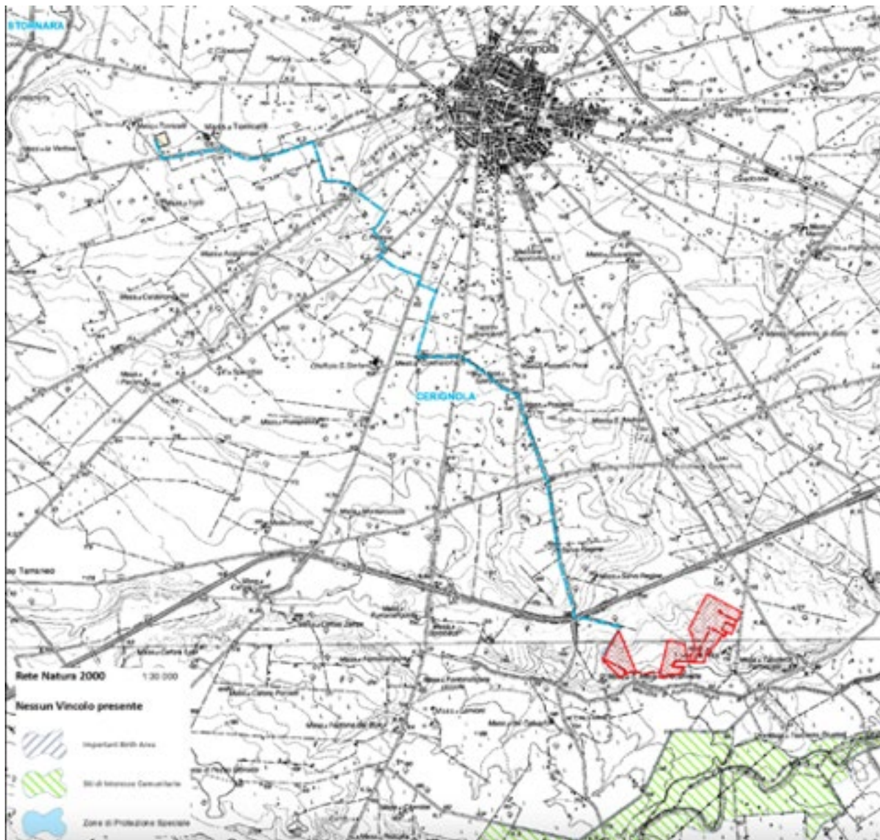
Figura 13: Impianto fotovoltaico e rete interrata di connessione a SE TERNA e siti appartenenti alla Rete Natura 2000.
