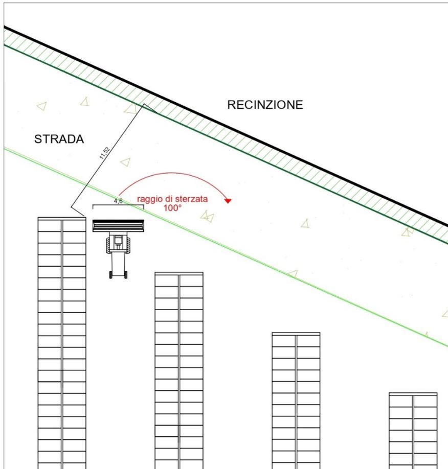
**Figura 8.** Rappresentazione del raggio di sterzata del macchinario per la trebbiatura
