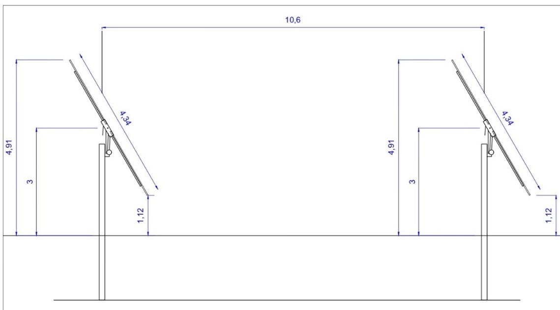
**Figura 3.** Caratteristiche del pannello
