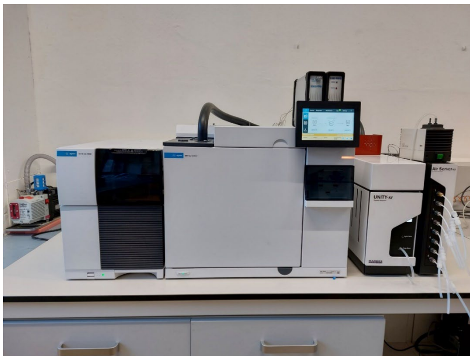
Figura 5. Strumento TD-GC-MS/FID/PFPD utilizzato nelle analisi
