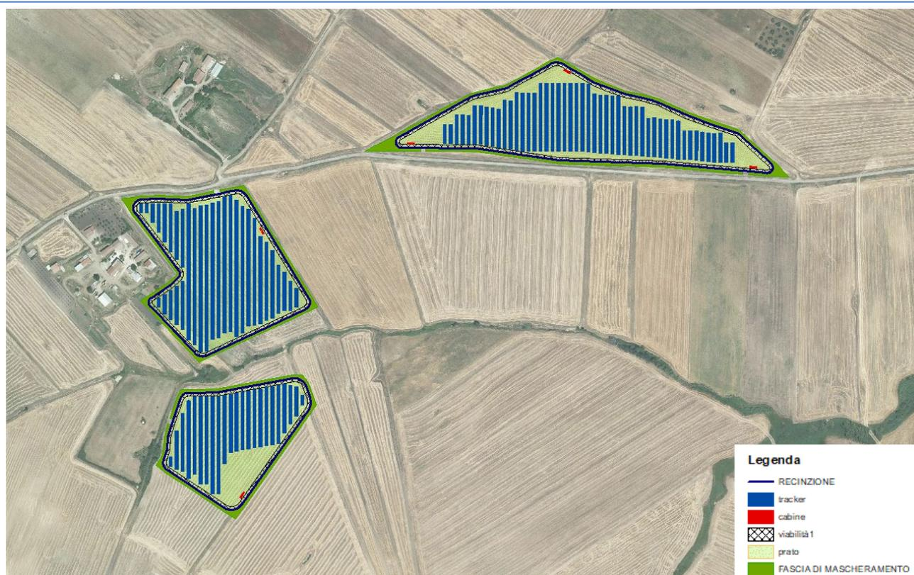
Figura 2.4.c – Area di progetto con indicazione del posizionamento dei moduli fotovoltaici-dettaglio
