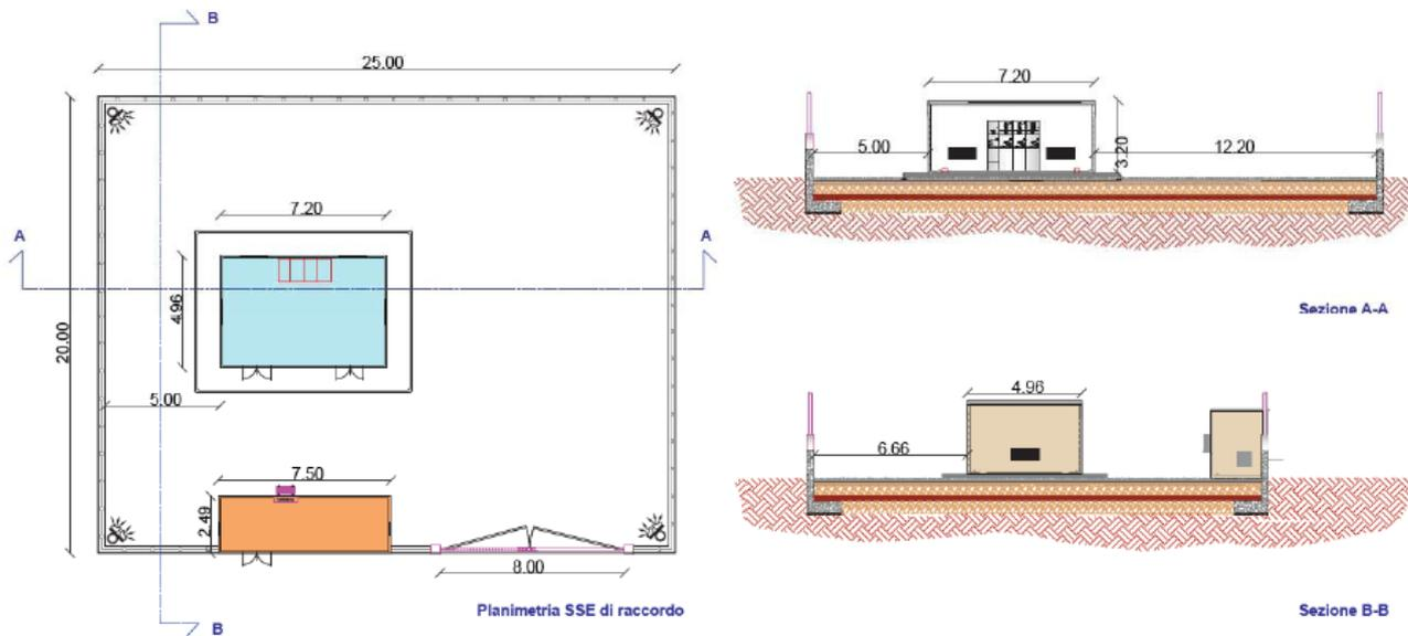
Per il campo fotovoltaico da realizzarsi in località "La Candida", la Soluzione Tecnica Minima Generale prevede che l'impianto venga collegato in antenna a 36 kV su una alla futura Stazione Elettrica di Trasformazione (SE) della RTN 380/150 kV da inserire in entra-esce sulla linea RTN a 380 Kv "Melfi 380 – Genzano 380".
