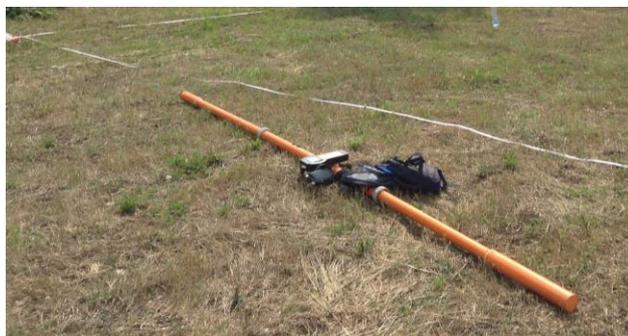
Figura 2: Elettromagnetometro CMD.
