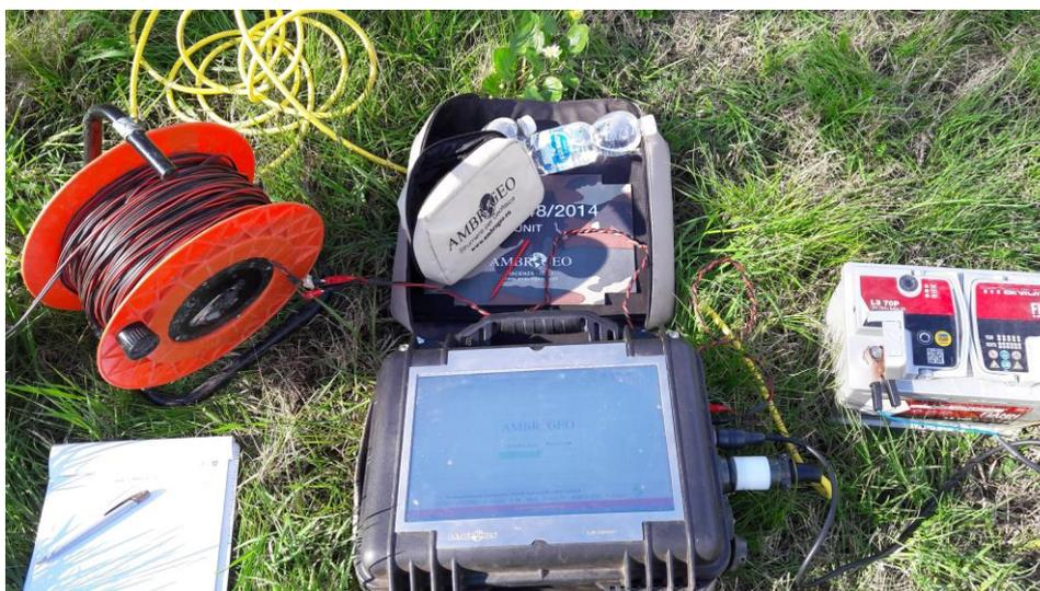
Figura 4: Sismografo digitale a 24 bit.
