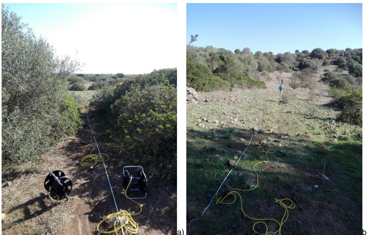
*Figura 5 a e b: Particolari illustranti le pendenze in gioco e l'allestimento di linee sismiche per onde di compressione e di taglio*
