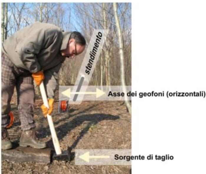
Figura 14 Acquisizione di dati utili ad analizzare la rifrazione delle onde SH e delle onde di Love (indicata la direzione dell'asse di sensibilità dei geofoni, perpendicolare allo stendimento – vedi anche Figura 2).
