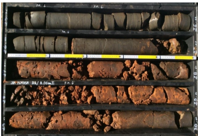
Foto 4 – Sondaggio S4, breccia profondamente alterata i matrice terrosa limo argillosa, tra 27m e tra 30m.
