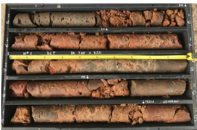
Foto 6 – Sondaggio S5, Breccia lavica profondamente alterata di colore rossastro ed arancio con tratti decimetrici di argilla (R0,R1, ISRM, 78), rinvenuta tra 5m e tra 10m.
