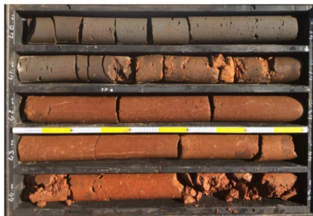
Foto 5 – Sondaggio S4, Breccia lavica in matrice terrosa marone, di natura limo argillosa profondamente alterata, tra 42m e tra 45m.
