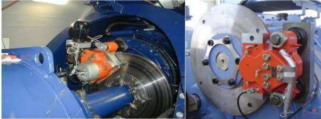
Figura 19. Sistemi di freno a disco sull'asse-rotore. Il sistema di controllo invia un segnale di frenata del rotore che fa variare il passo delle pale, le pinze bloccano il movimento residuo della rotazione
