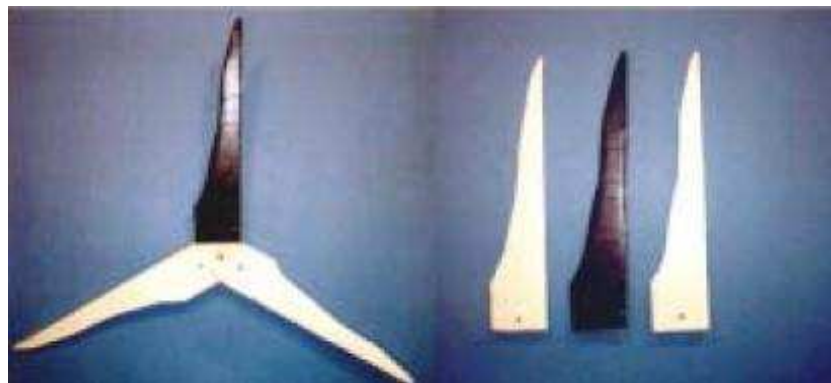
Figura 13. Due esempi di pattern proposti dallo studio di Hoods e colleghi e sottoposti a test. In questo esempio è riportato un pattern a singola pala colorata uniformemente di nero ("solid black")
