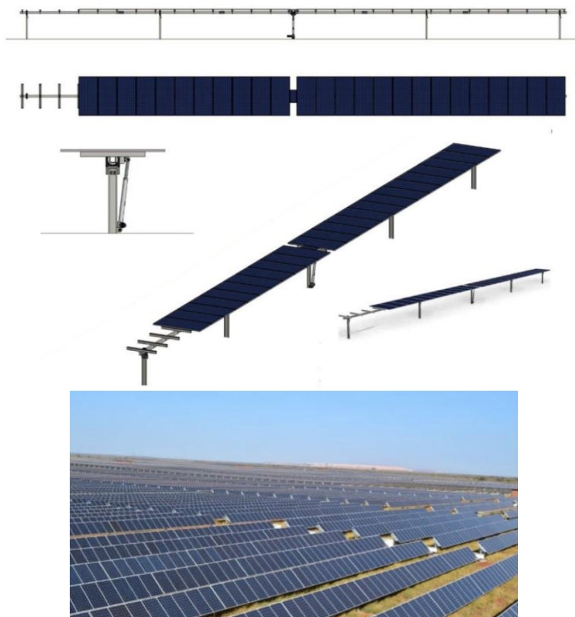
Modello 3D e fotografie esemplificative dei trackers utilizzati nel progetto
