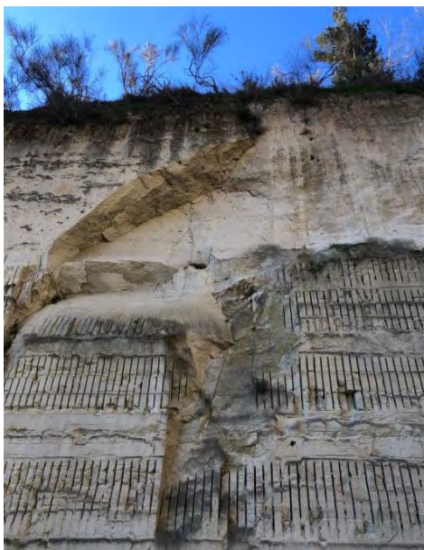
FIGURA 27: NICCHIA DI DISTACCO PER SCIVOLAMENTO PLANARE NEL TUFO LITOIDE (FRONTE OVEST R3)
