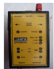
FIGURA 21: CARATTERISTICHE TECNICHE SISMOGRAFO DOREMI SARA ELECTRONIC INSTRUMENTS
