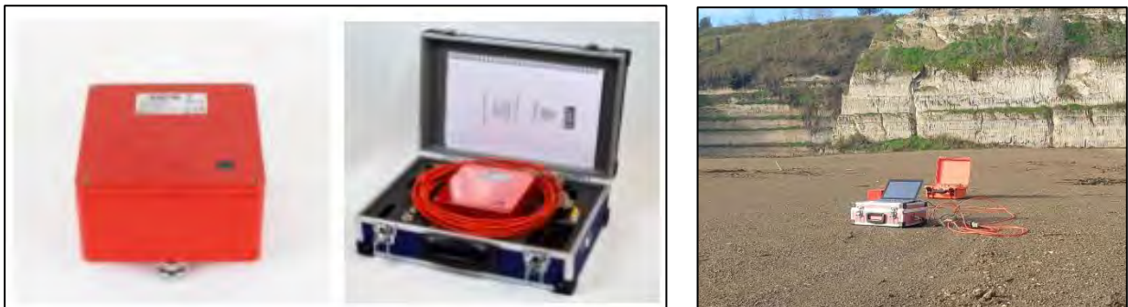
FIGURA 23: SISMOGRAFO TRIASSIALE UTILIZZATO PER LA PROVA PRESSO RIANO
