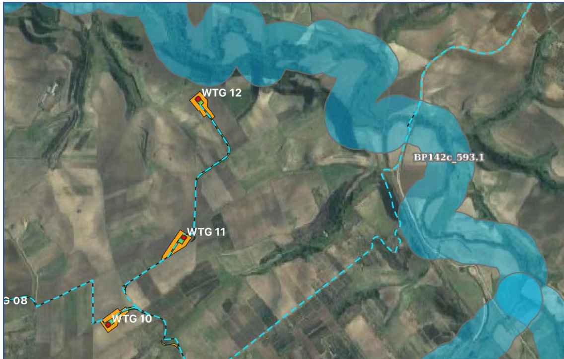
Figura 9- Interferenza del cavidotto con la "Fiumara di Venosa, Fiumara Matinella, la Fiumara"
