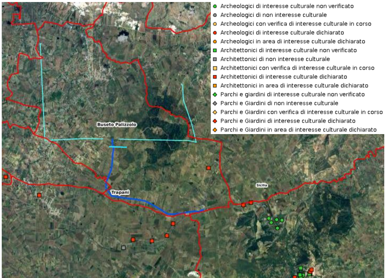
Figura 3.20: Estratto della Cartografia di Vincoli in Rete con rappresentazione in blu della linea di elettrodotto aereo 150 kV in progetto e in celeste di quella esistente a cui raccordarsi. In rosso i limiti comunali.
