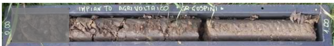
FIGURA 3.8 – Terre colluviali estratte dal sondaggio S4.
