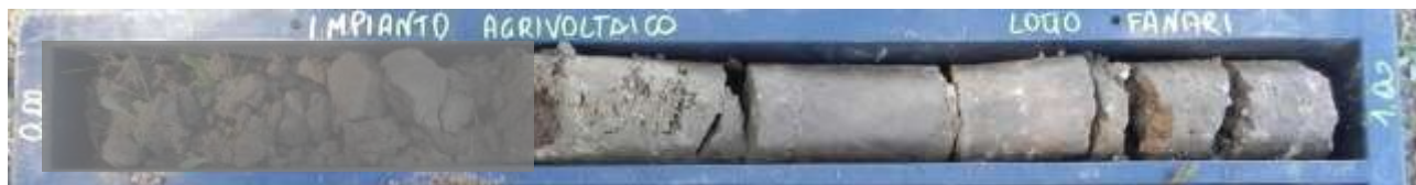
FIGURA 3.11 – Argilla limosa estratta dal sondaggio S5.
