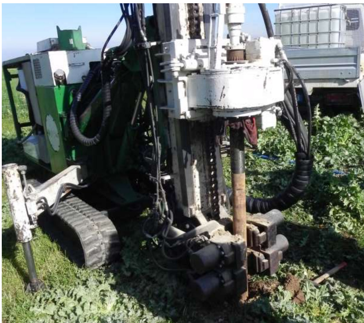
FIGURA 2.2 – Dotazioni tecniche della sonda idraulica impiegata per i sondaggi.
