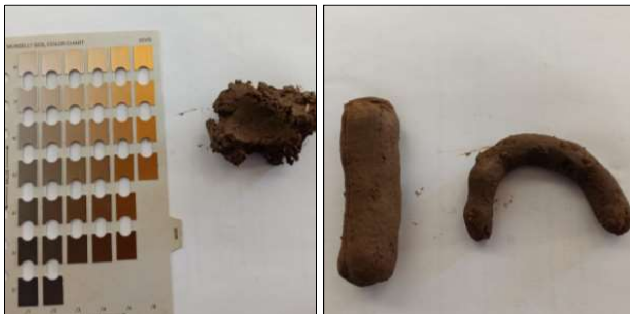
Figura 5.4 - Analisi colori con Munsell Soil Color Chart Figura 5.5 - Prova dei cilindretti per stima tessitura
