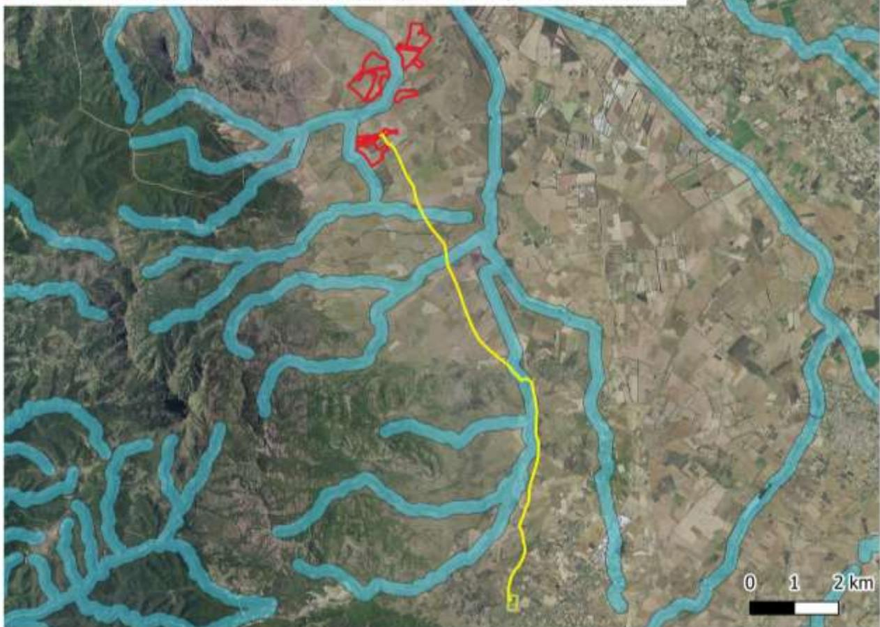
Figura 7.1 - Sovrapposizione del cavidotto a 36 kV ivi impostato su viabilità esistente con fasce di tutela paesaggistica di 150 m (art. 142 D.Lgs. 42/04)
