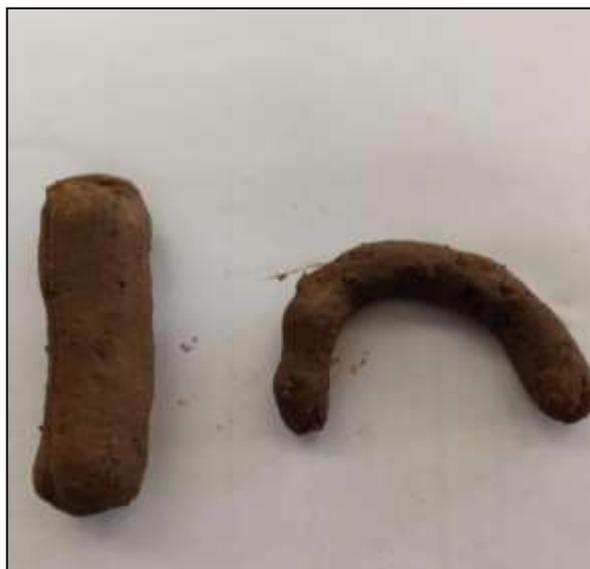
Figura 4-9 - Analisi colori con Munsell Soil Color Chart    Figura 4-10 - Prova dei cilindretti per stima tessitura
