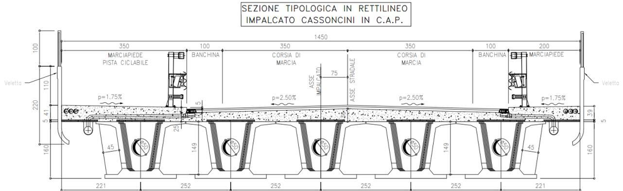
Figura 4 - Sezione tipologica impalcato in c.a.p.
