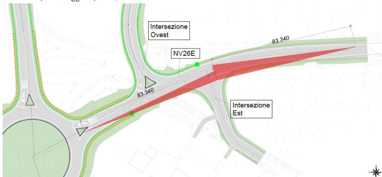
Figura 16: Verifica intersezione a raso NV26E lato Est
