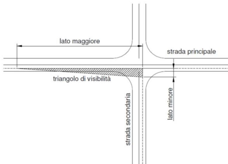
Figura 14: Schema triangoli di visibilità
