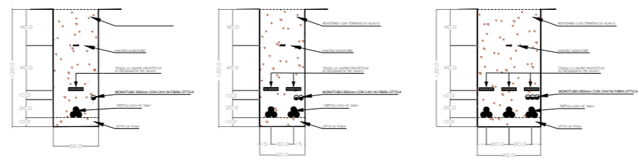
SEZIONI TIPICHE VIE CAVO SU STRADE BIANCHE (ESISTENTI / di NUOVA REALIZZAZIONE)
