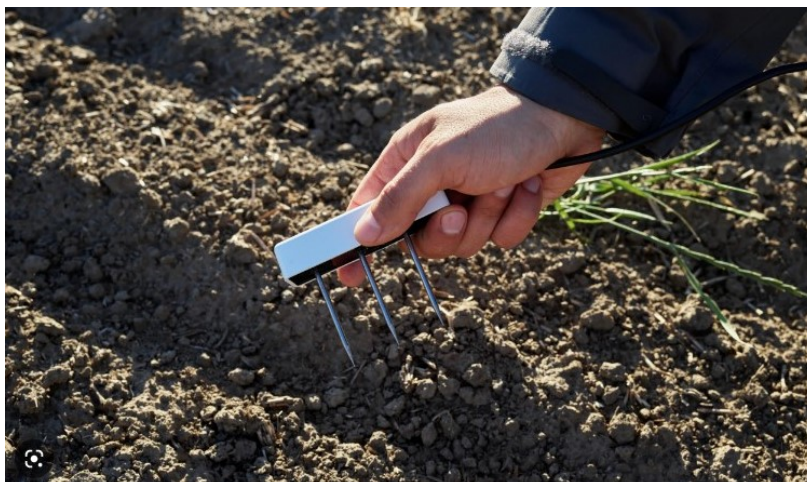
Figura 25: Sensore TERO12 (Meter) da inserire per il monitoraggio delle colture dell'ulivo e degli alberi della famiglia del tartufo
