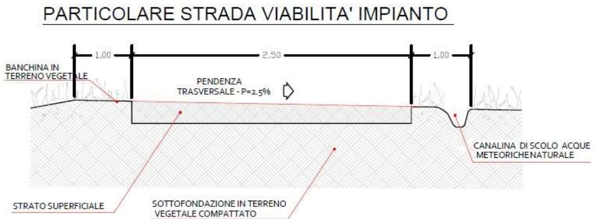
Figura 6: Sezione stradale della viabilità interna d'impianto
