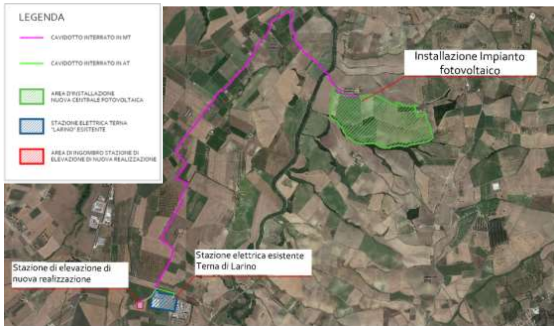
Figura 4: Stralcio ortofoto con individuazione della stazione di elevazione e di smistamento di nuova realizzazione
