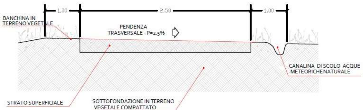
Figura 2: Sezione stradale della viabilità interna d'impianto
