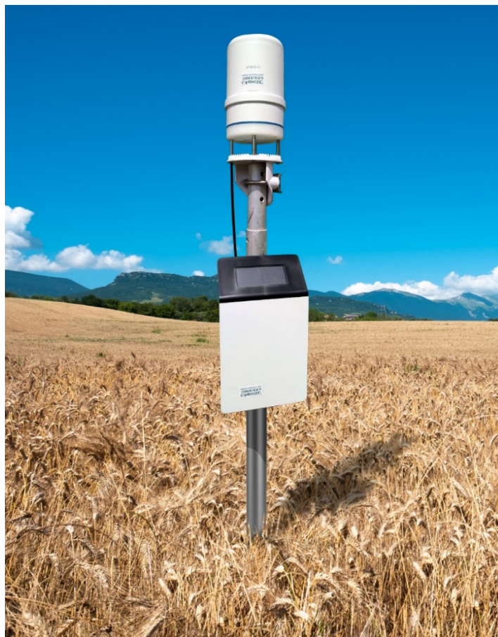
Figura 23 - Stazione meteo ATMOS41 + datalogger ZL6 (Meter) con due sensori di PAR, da inserire in pieno campo
