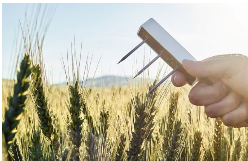
Figura 25 - Sensore Teros12 (Meter) da inserire per il monitoraggio delle colture impiantate tra le interfile dei tracker
