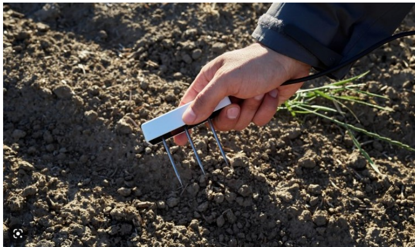
Figura 24 - Sensore Teros12 (Meter) da inserire per il monitoraggio delle colture dell'ulivo e degli alberi della famiglia del tartufo
