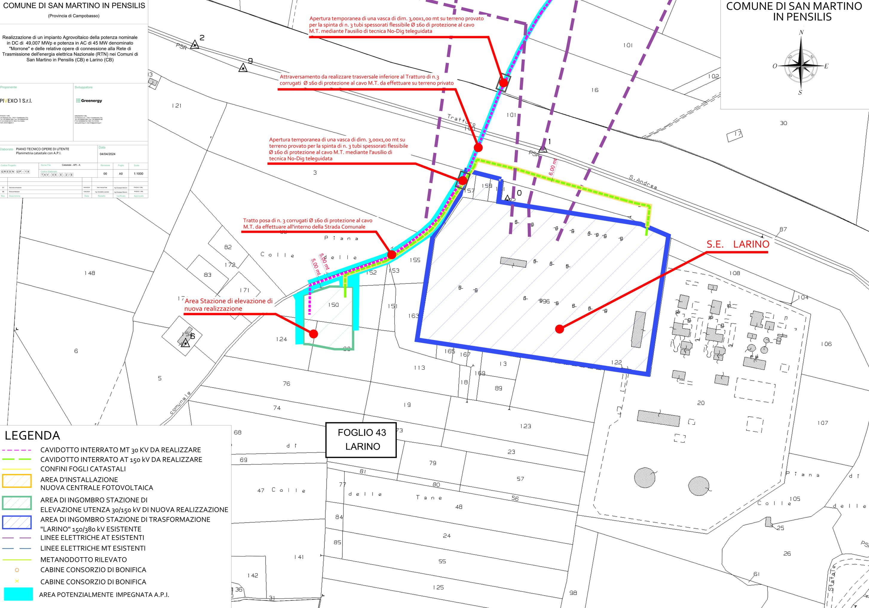
Apertura temporanea di una vasca di dim. 3,00x1,00 mt su terreno provato per la spinta di n. 3 tubi spessorati flessibile Ø 160 di protezione al cavo M.T. mediante l'ausilio di tecnica No-Dig teleguidata
