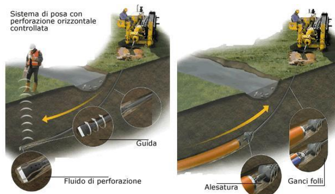
Fig. 1.2: Posa in opera tubazione per alloggiare cavi
