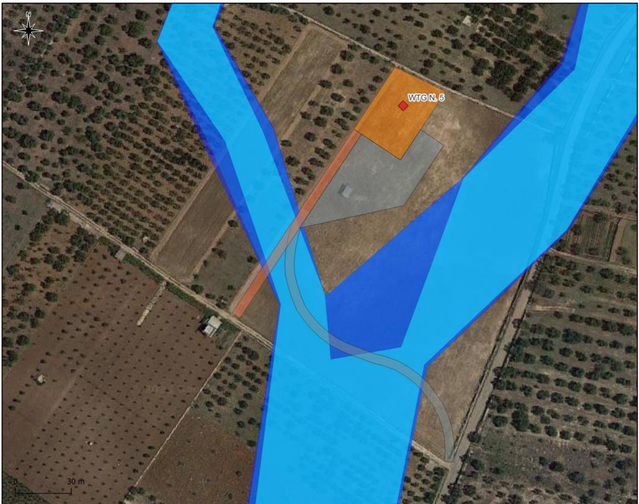
Inquadramento su ortofoto dell'intersezione delle opere temporanee (in grigio) e permanenti (in arancione) con le aree allagabili da modellazione idraulica
