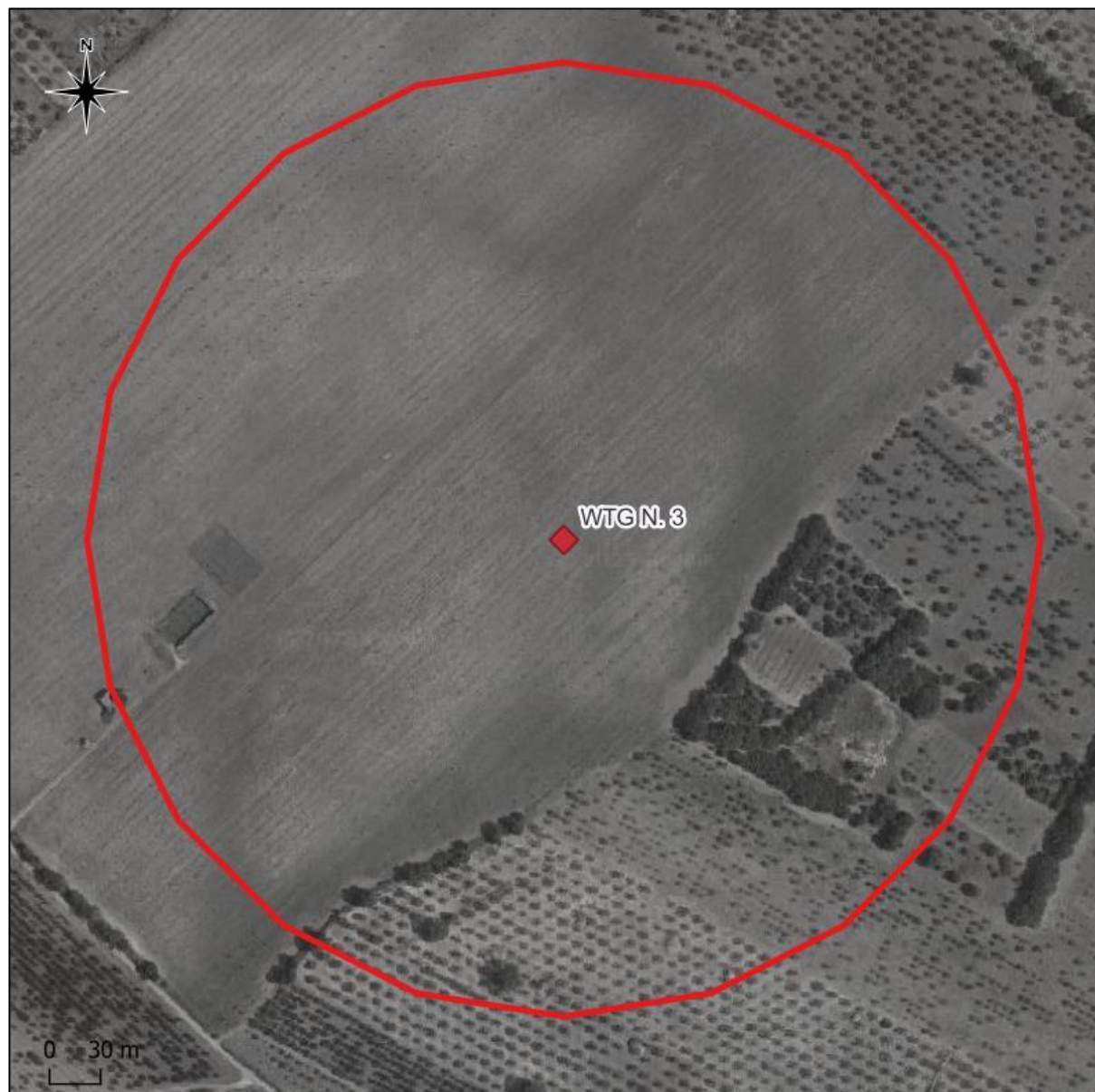
Buffer di 280 m dalla WTG N. 3 – Nessun edificio classificato come ricettore presente nel buffer
