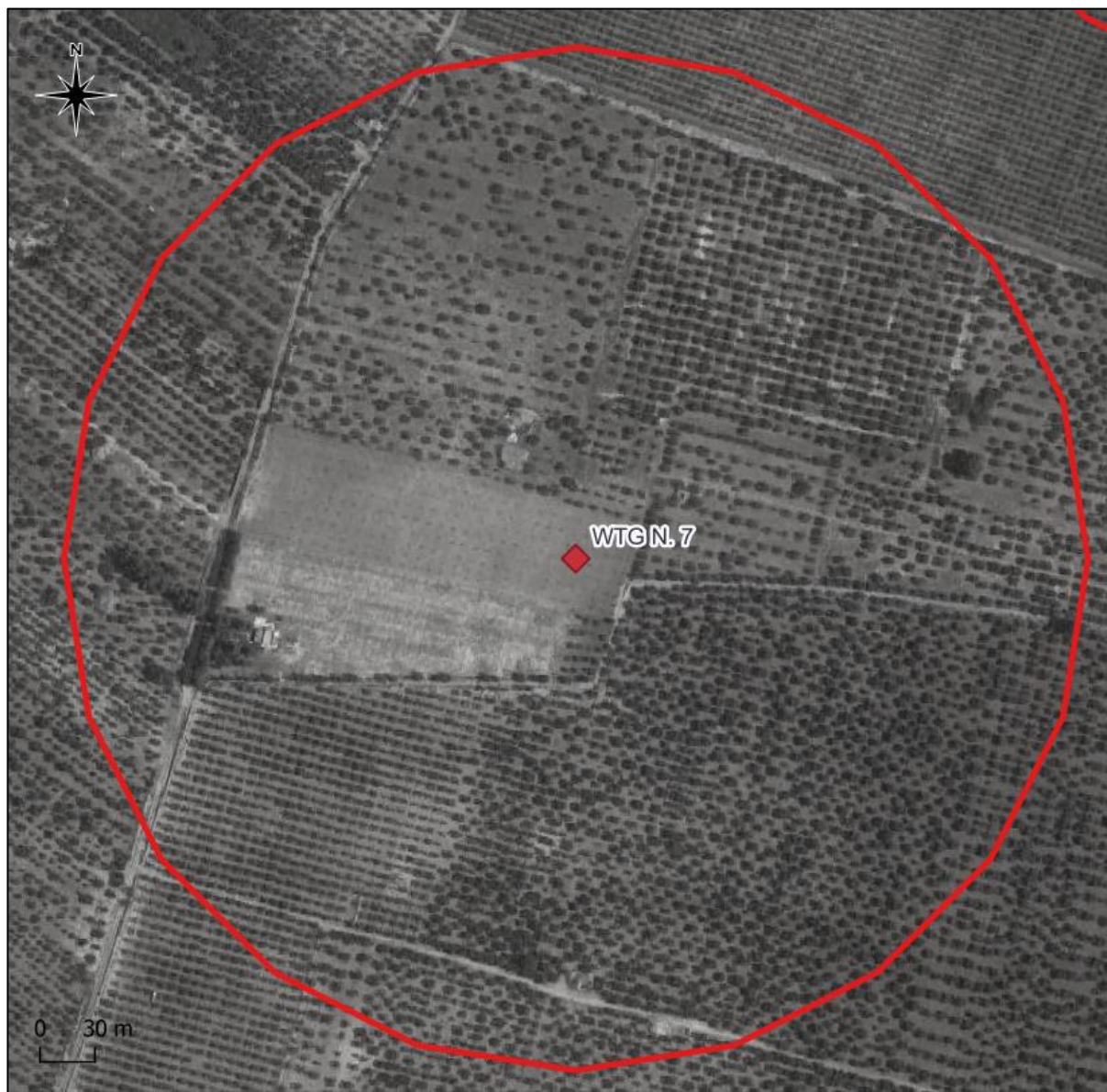
Buffer di 280 m dalla WTG N. 7 – Nessun edificio classificato come ricevitore presente nel buffer
