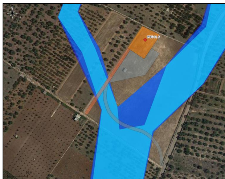
Inquadramento su ortofoto delle intersezioni delle opere temporanee (in grigio) e permanenti (in arancione) con le aree allagabili
