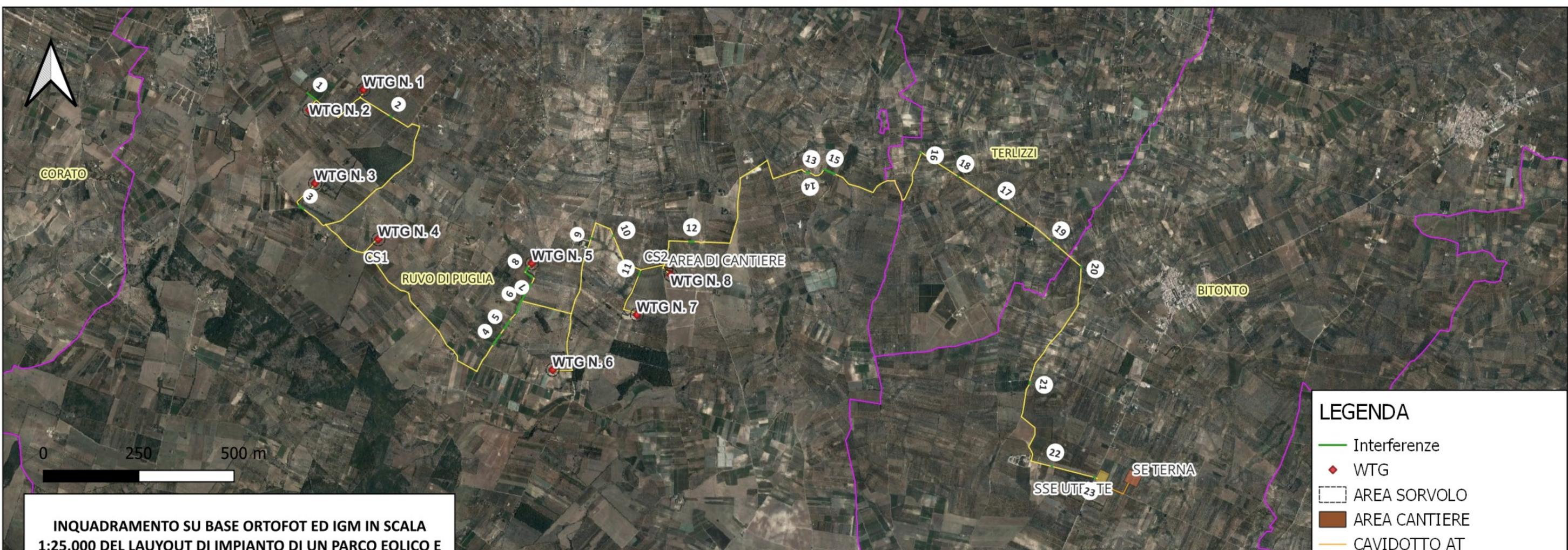
**INQUADRAMENTO SU BASE ORTOFOT ED IGM IN SCALA 1:25.000 DEL LAUYOUT DI IMPIANTO DI UN PARCO EOLICO E PANORAMICA DELLE INTERFERENZE INDIVIDUATE NEL PERCORSO DEL CAVIDOTTO IN AGRO DI RUVO DI PUGLIA (BA)**
