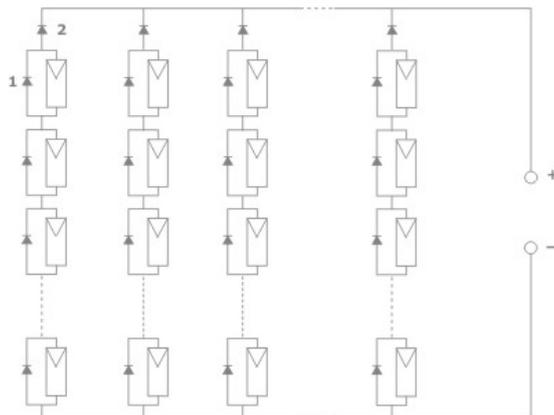
**Figura 1: esempio di sottocampo fotovoltaico con stringhe**
