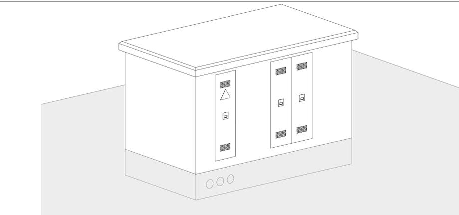
**Assonometria cabina parallelo BT tipo**
