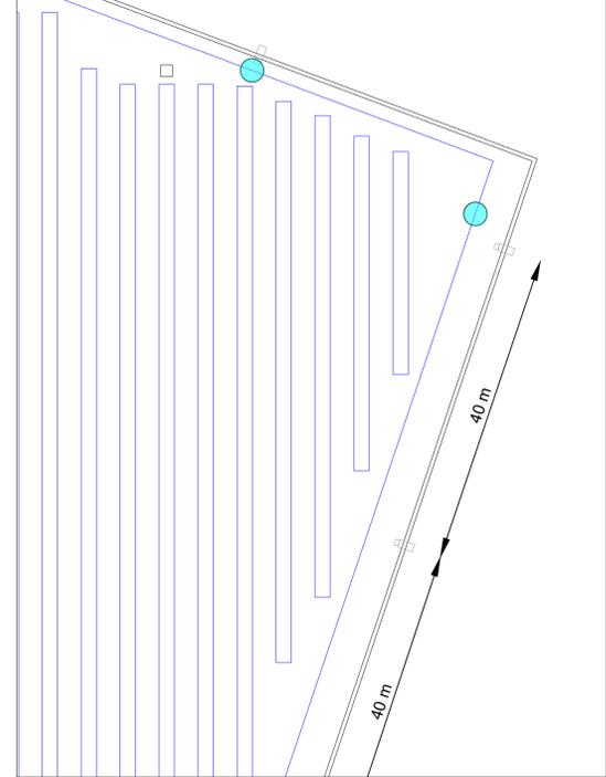
PARTICOLARE: Sistema di sorveglianza\_ Distanza MAX barriera ad infrarossi
