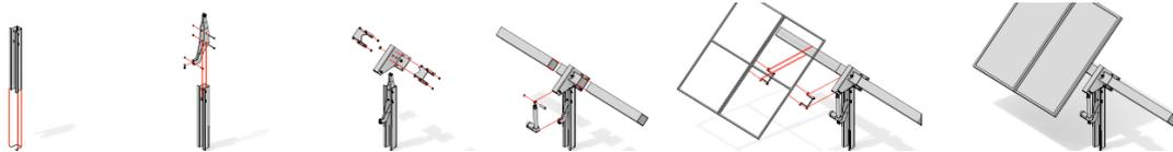
L'utilizzo di questo tipo di sostegni consente un'esposizione ottimale dei pannelli fotovoltaici all'irraggiamento solare grazie alla scelta della struttura che sarà ad inseguimento monoassiale e quindi una maggiore produzione per superficie captante ed occupata in quanto il software ottimizza l'angolo.
