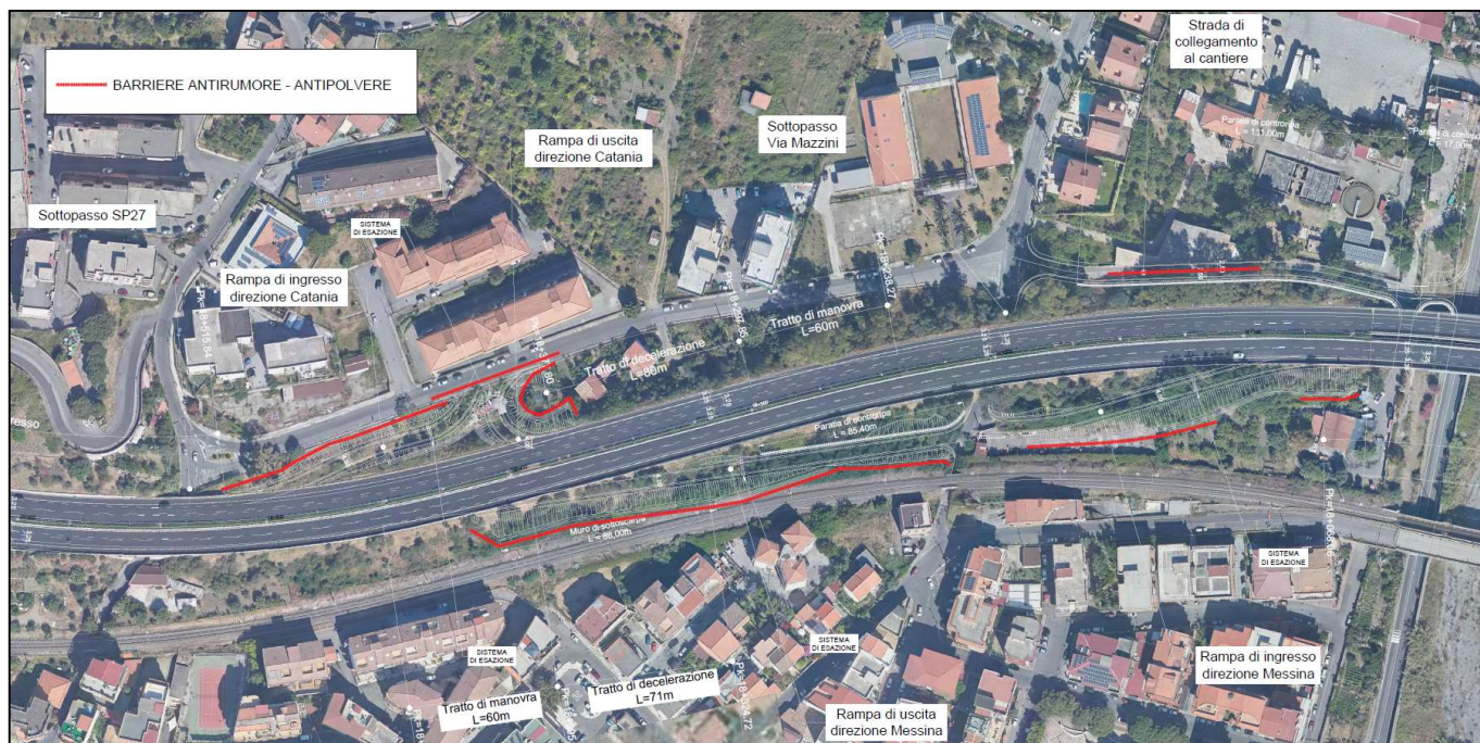
Innesto Nizza di Sicilia-Stralcio aerofotogrammetrico con disposizione barriere mobili antirumore e antipolvere
