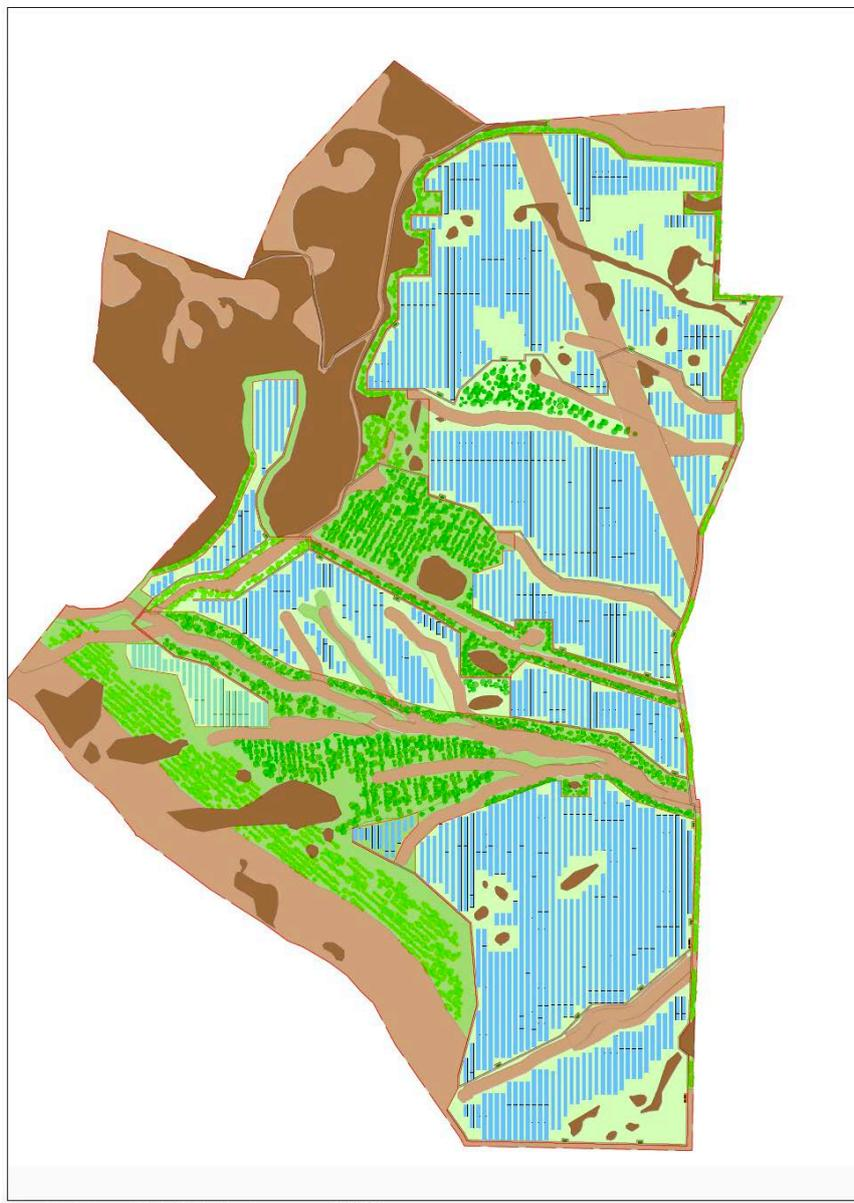
Figura 2: Layout impianto (in azzurro i moduli FTV)
