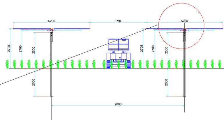
**Tracker - Sezione di dettaglio**
