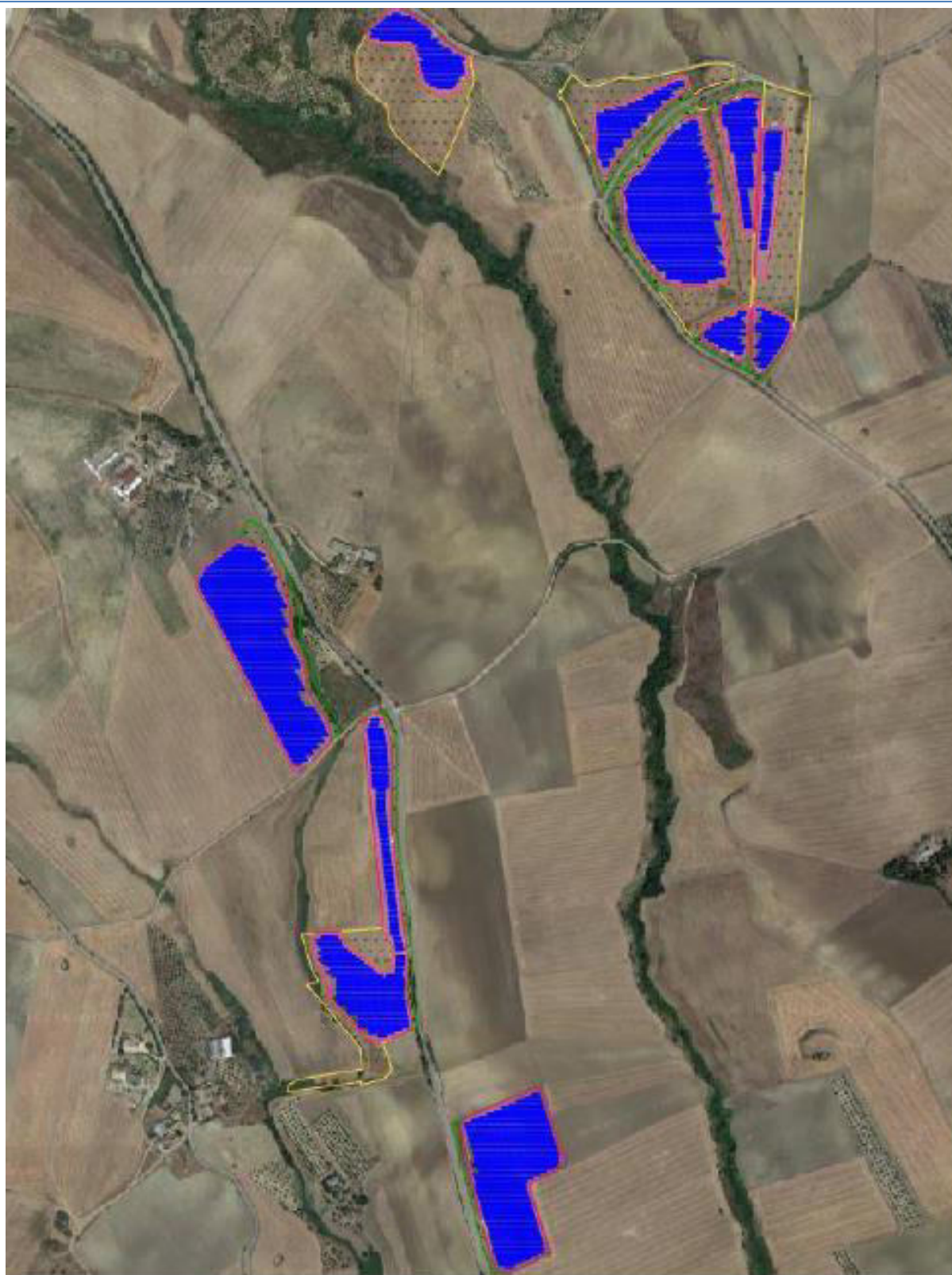
Figura 7.4. – Layout del sistema agrivoltaico con supporti fissi.
