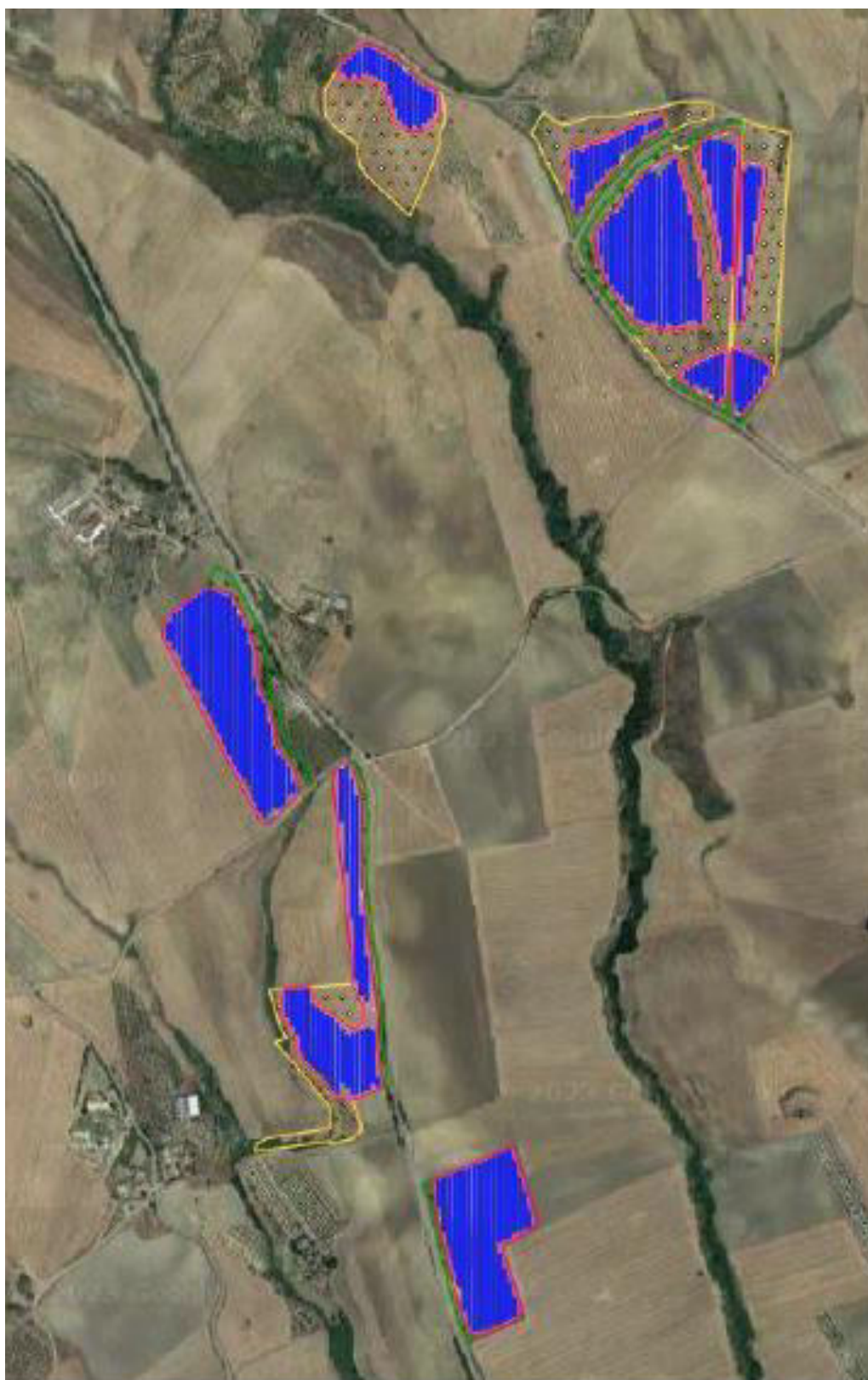
Figura 7.2. – Layout del sistema agrivoltaico con tracker.
