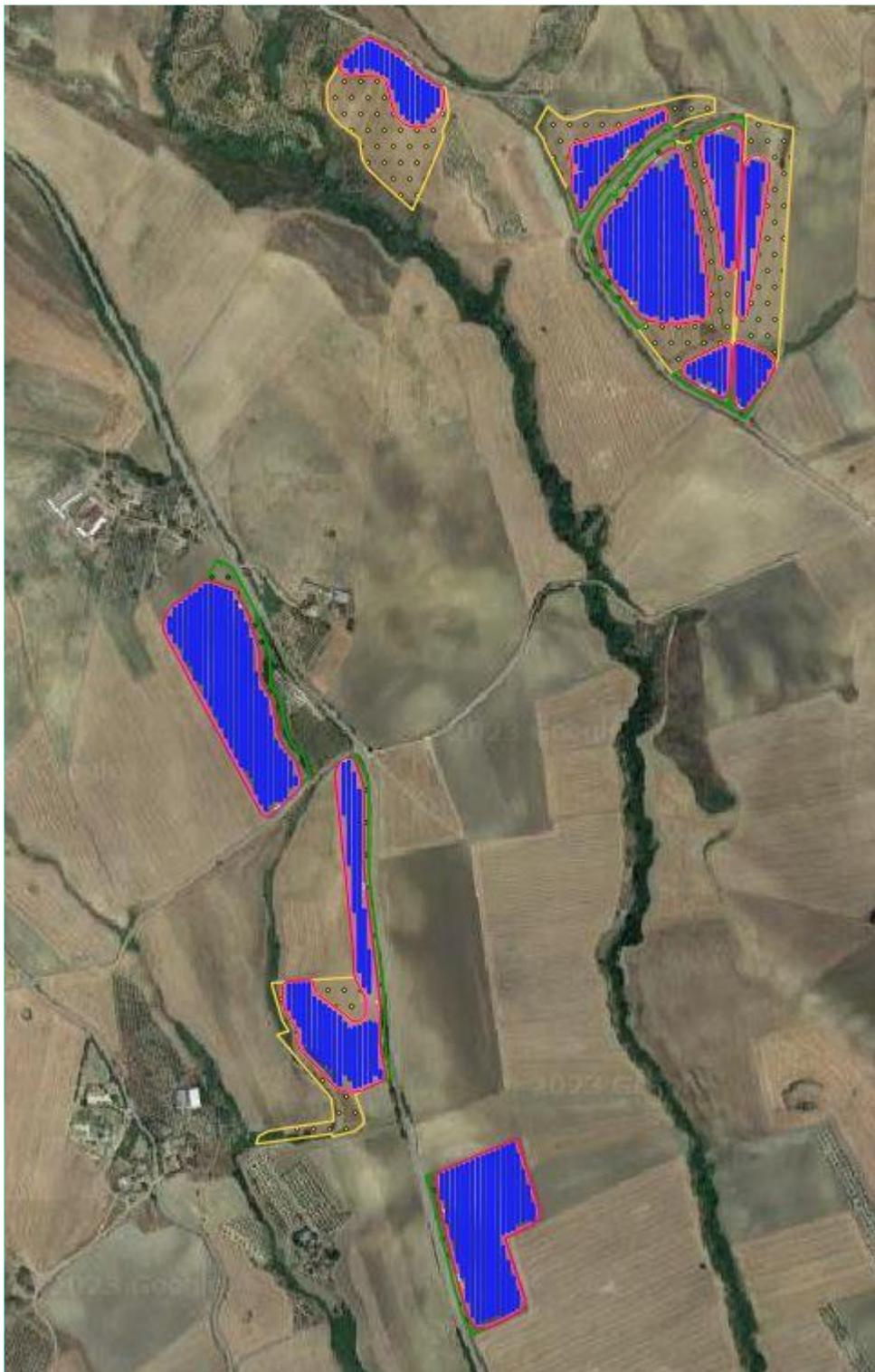
Figura 3.2. – Layout del sistema agrivoltaico con tracker.
