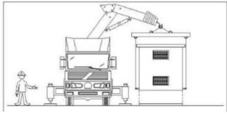
Le caratteristiche della cabina monoblocco consentono la recuperabilità integrale del manufatto con possibilità di poterla spostare e riutilizzare in altro luogo.
