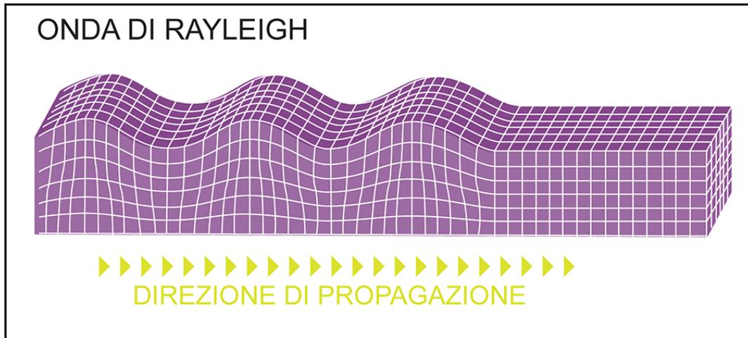
Figura 20. Rappresentazione schematica dell'onda di Rayleigh.
