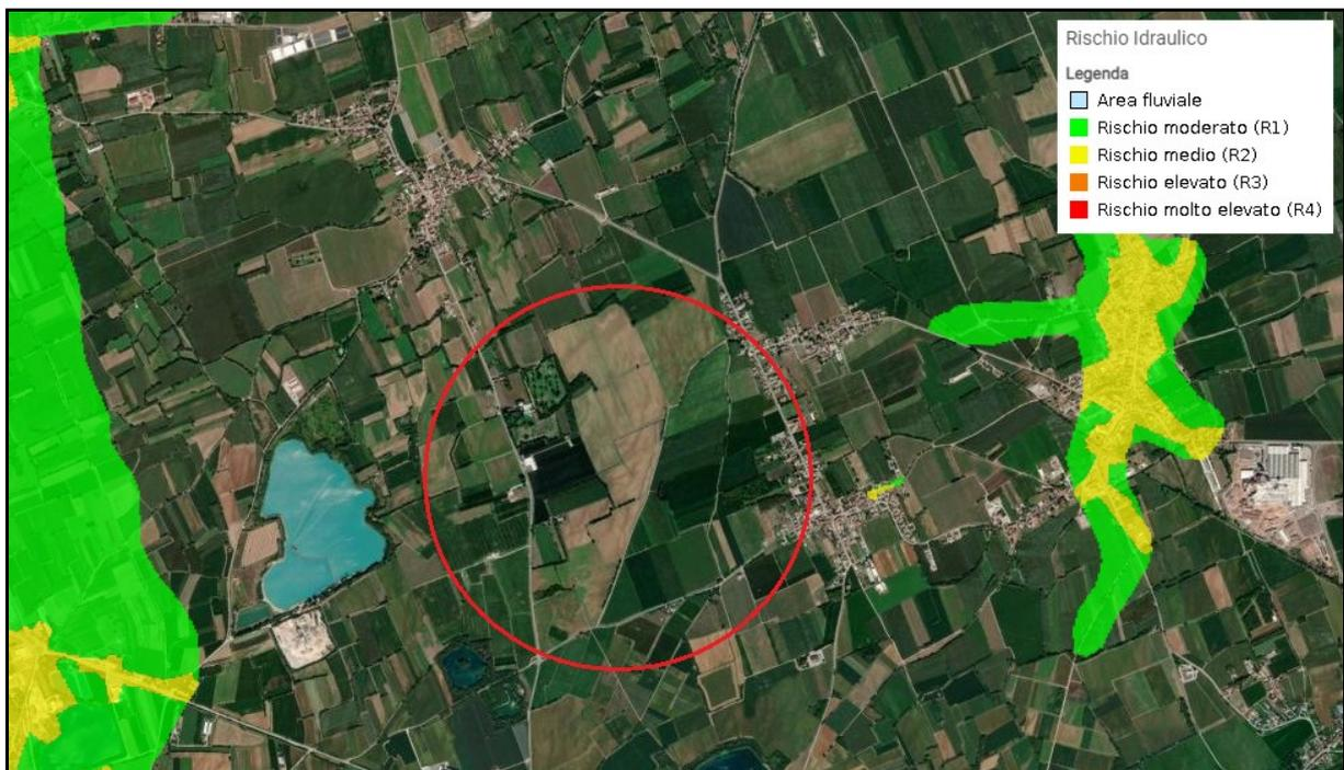
Figura 2. Particolare del rischio idraulico nell'area di interesse
