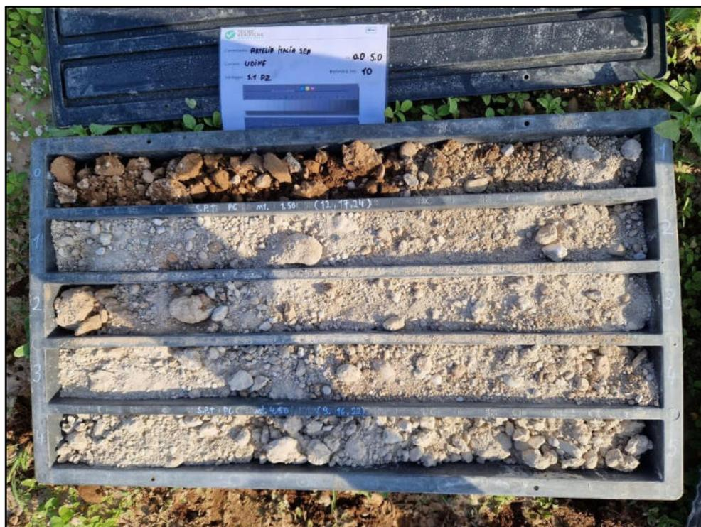
Fig. 4: Cassetta catalogatrice da 0 a 5 m del sondaggio S1
