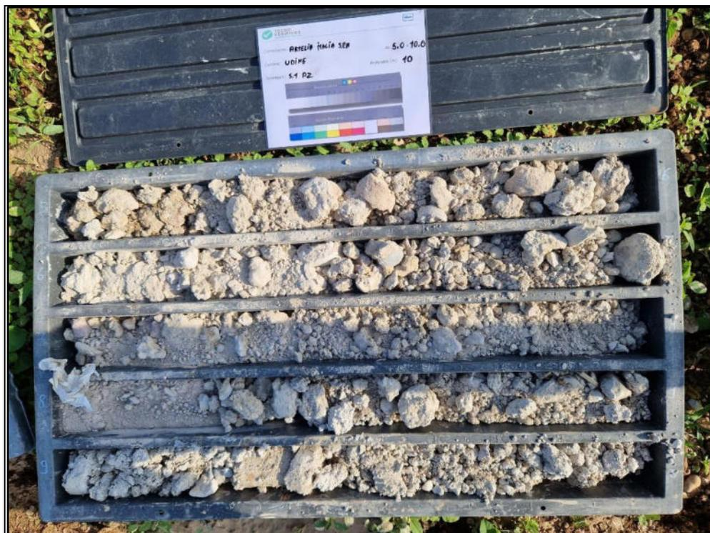
*Fig. 5: Cassetta catalogatrice da 5 a 10 m del sondaggio S1*
